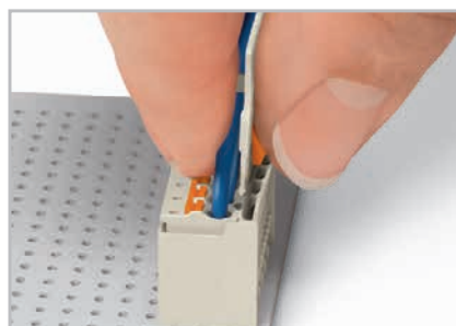
Empurre para baixo a deslizando o conector (placa de fixação) para abrir a aba de travamento.
