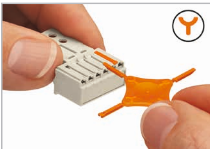
Codificação de um conector fêmea (através de suporte de chave de codificação 209x-1610 e duas chaves para conector fêmea, veja o símbolo).
